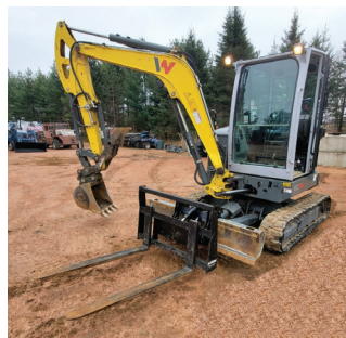
MINI EXCAVATOR SHOWN WITH PALLET FORKS ON BLADE
